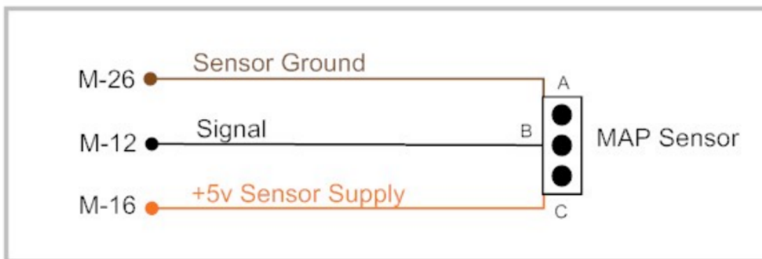
マニホールド絶対圧センサーの配線
