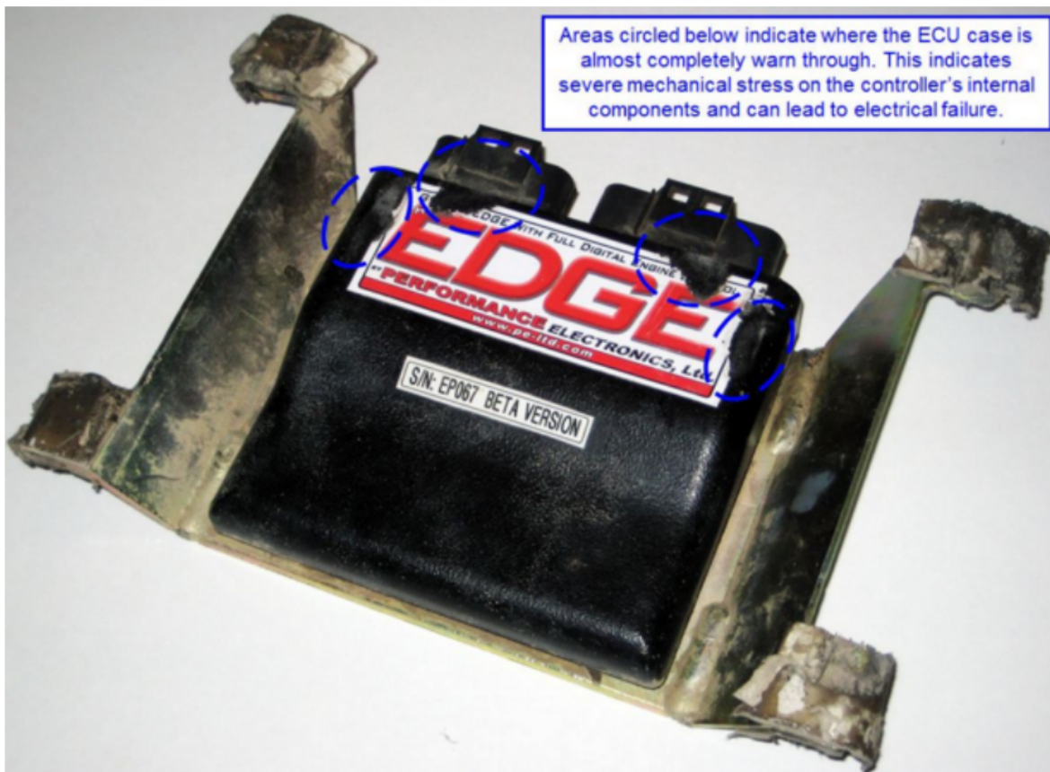
未熟な内部破壊に起因するECUの機械的損傷
